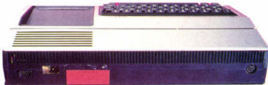
La partie arrière du TI-99/4A. De gauche à droite : la prise neuf broches pour raccorder un magnétophone à cassettes, la prise quatre broches pour le câble d'alimentation et la prise DIN à six broches pour connection à un téléviseur.
